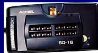
Sequenzkamera ACMEL SQ-16 16 Sequenzbilder 2 Negative belichtet
